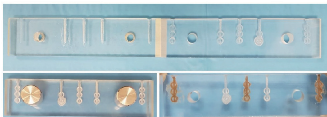
圖一：實驗所使用的透明樹脂模型，內含人造根管。 樹脂模型可以分成兩半，方便將製作出的殘屑注入根管中進行實驗。
